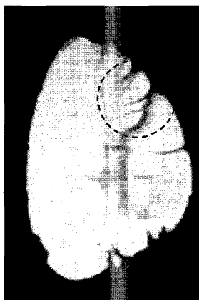
(a) 균질한 재료에서의 균열의 분할(Hubbert와 Willis, 1957) (b) 경계면에서의 균열의 Offset(Renshaw와 Pollard, 1995) (c) 보어홀내의 다중분할 균열(GRI, 1991)
