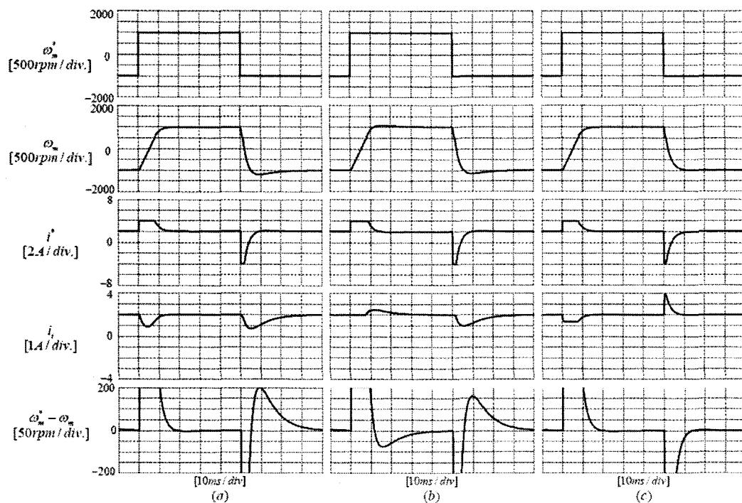
그림 10. 50%부하에서의 적분누적 방지기법 비교 (a) 추적역계산, (b) 조건적분, (c) 제안된 적분누적 방지기법 : 모의실험결과
