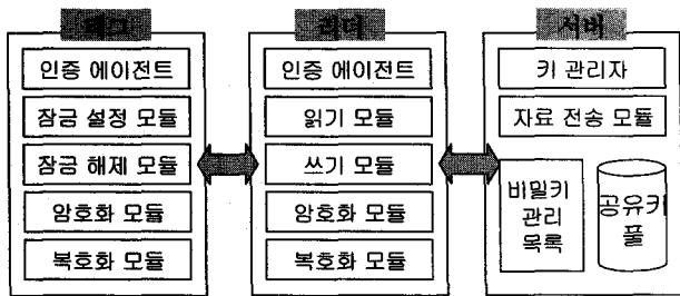
그림 1. 제안 시스템의 구성도 Fig. 1. Proposed Safe RFID system architecture.
