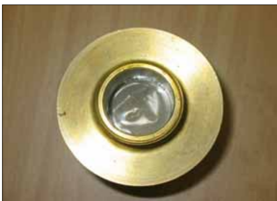
그림 5 유중가스 측정장치의 삼투막 파손 Fig. 5 Damage of the membrane of the gas in oil detector
