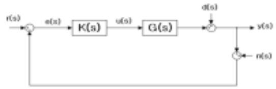
그림 2 일반적인 피드백 제어 시스템 Fig. 2 Feedback control system
