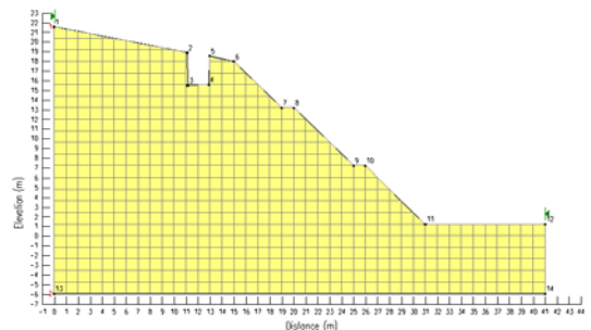
그림 4. 한계평형해석 mesh 형상 (산마루 측구 설치시)
