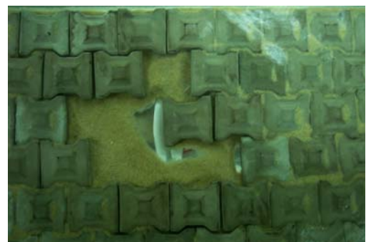
그림 8. I형 블록 이탈현상 및 세굴
