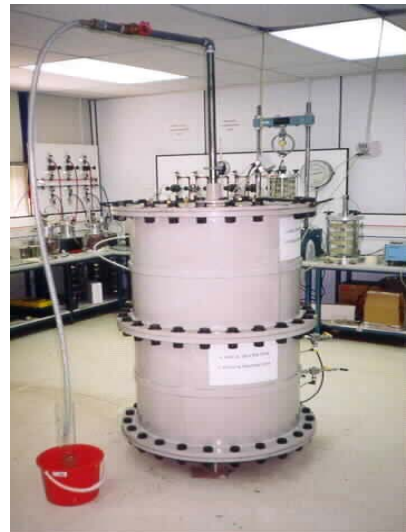
그림 1. 소형 간극수압계 및 지중계를 장착한 대형 압밀시험기
