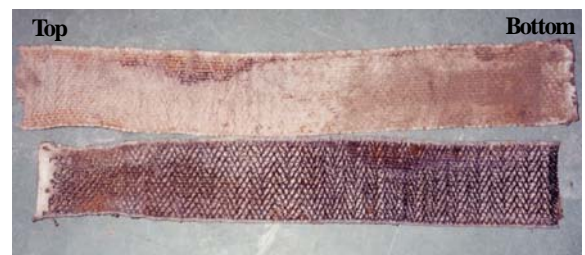
그림 3. 압밀시험 이후 분리된 시료 및 연직배수재
