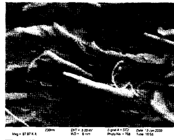
그림 2. 표면처리를 하지 않은 CNT로 만든 복합재료의 파괴 메커니즘.
