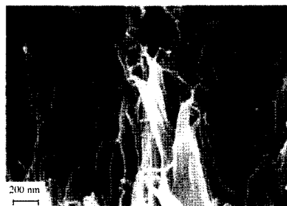
그림 12. PVA/SWNT 복합섬유의 파괴단면 구조. 20
