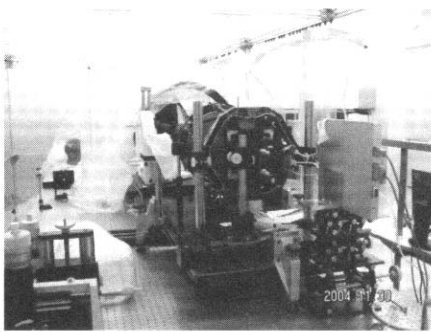
그림 4. MAC system MTF measurement setup
