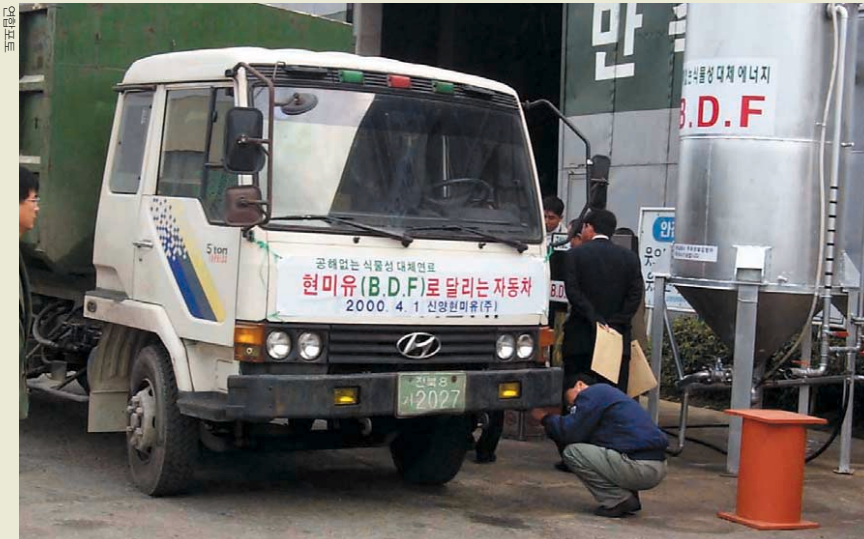
전북 정읍시 제1공단 신영현미유주식회사(대표 이광중)가 쌀겨를 원료로 개발한 '바이오디젤유'의 제품실명회를 열고 연료를 주입한 화물차의 매연 등을 공개 측정하고 있다.
