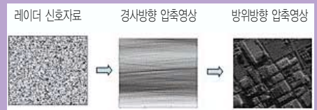
<그림 2> 수집된 레이더신호자료를 영상으로 만드는 과정
