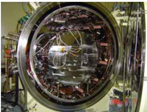
그림 1. 항우연 Bake-Out 챔버 내부에 설치된 용기 모델
