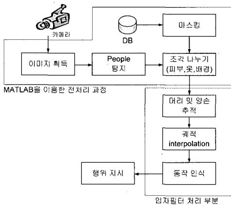
그림 1. 전체 시스템 동작 과정
