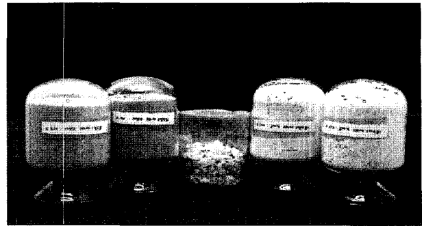
그림 1. 시멘트계 고화재(사진 왼쪽)와 굴패각 고화재(사진 오른쪽)의 모습
