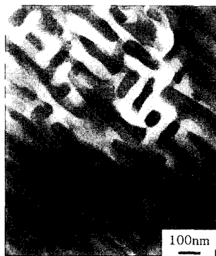
그림 19 저탄소강/NiAl 연소합성반응 주조접합법으로 제조된 접합계면의 TEM 조직. 흑색과 백색은 각각 NiAl과 강 조직을 나타낸다.
