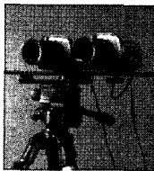
그림 2. CCD 컬러 카메라 Fig 2. CCD Color Camera
