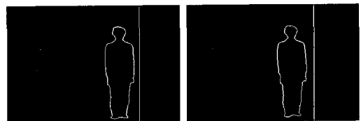
그림 6. 몸동작 객체의 윤곽선 추출 (왼쪽 / 오른쪽) Fig 6. Contour extraction of body object (Left / Right)
