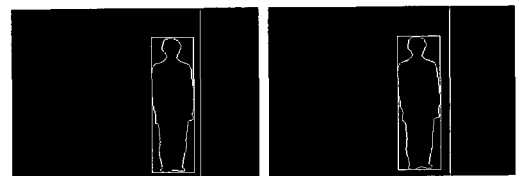
그림 7. 객체 윤곽선의 사각형 영역 추출 (왼쪽 / 오른쪽) Fig 7. Extraction of rectangle region of body object (Left / Right)
