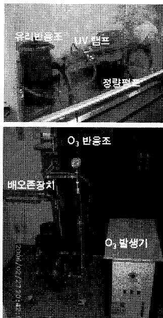
Fig. 3.17. Lab-Scale AOP 반응조 및 AOP의 종류에 따른 2,4- DCP, DEP의 제거효율 평가.
