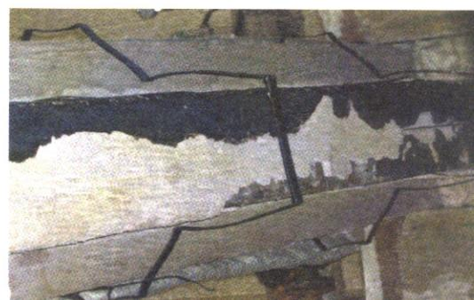
그림 10. 가력 후 내화 피복 탈락방지용 앵글 설치 형상
