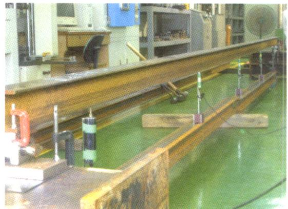
그림 4. 실험을 위한 단순보 설치 전경
