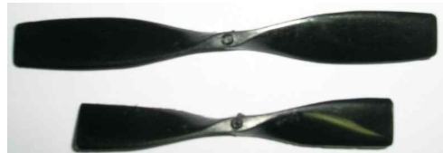
위: U-80 프로펠러(80mm) 아래: 추진시스템에 최적화된 프로펠러(58mm)
