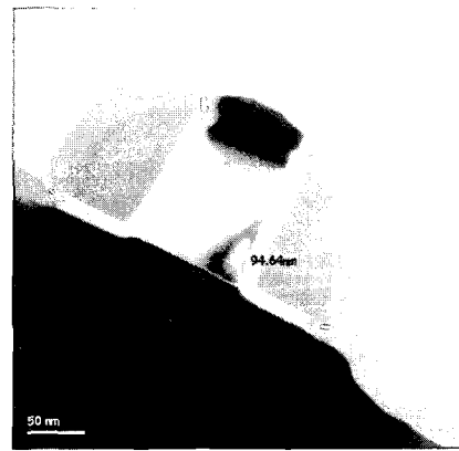
그림 2. 0.13 μm CMOS 기술을 이용하여 제작된 MOSFET의 XTEM 단면도 Fig. 2. XTEM image of MOSFET fabricated with 0.13 μm CMOS technology.
