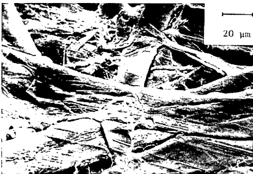
Fig. 9. 온도 경사 캘린더링한 신문용지 표면에 나타난 금속 롤의 스크래치 자국.
