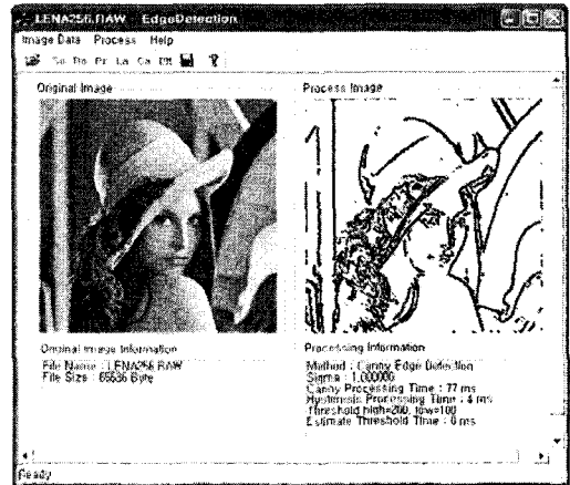
(그림 6) 입력 영상과 Canny 방법에 의한 결과
