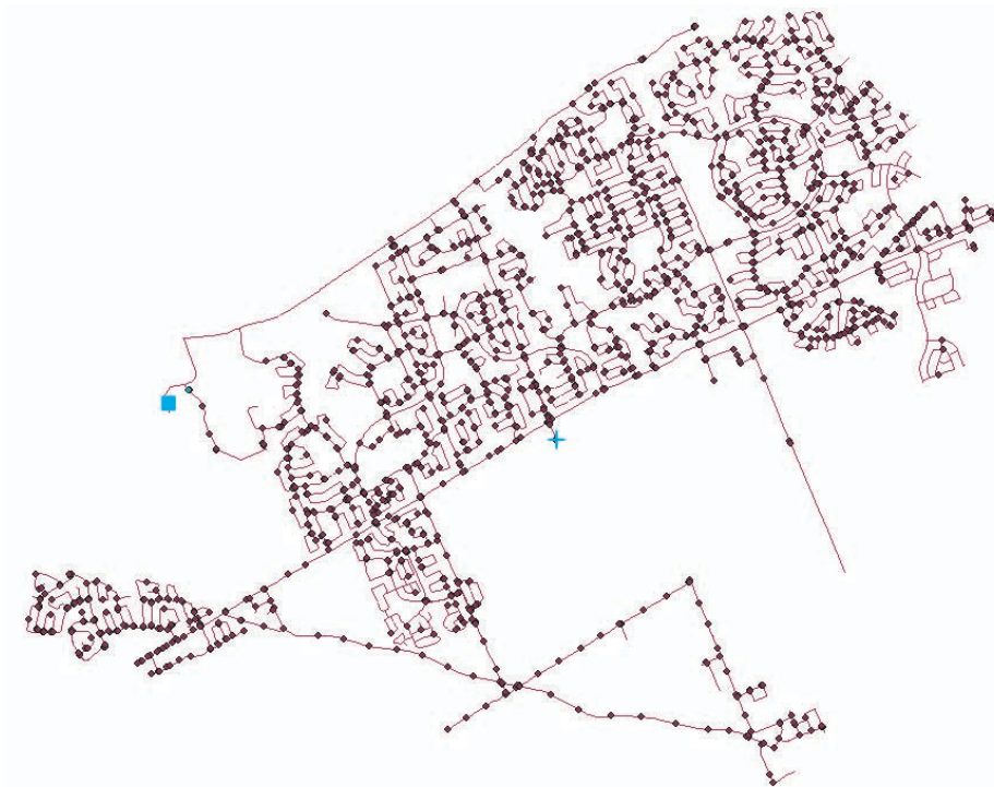
Fig. 6. 적용대상 관망의 관망형태, 절점(점), 저수지(사각), 및 탱크(십자).
