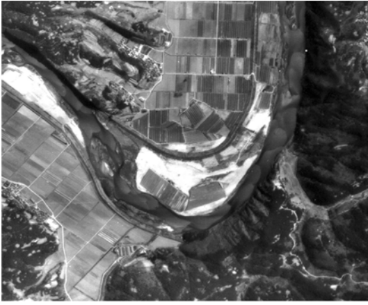
그림 1. 사행하천에서 교호사주의 모습: 황강의 항공사진(2000.3)이며, 흐름 및 사주는 좌측 위에서부터 사행의 만곡부를 지나 위(북쪽)로 이동한다
