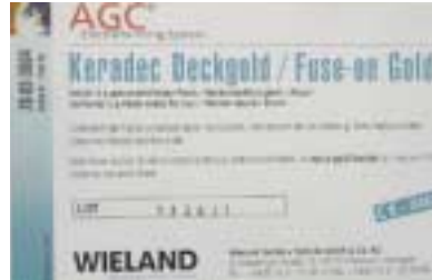
Keradec - sintering (920~940°C에서 3분간계류)시 AGC gold와 ceramic alloy를 완전히 융착시킨다.
