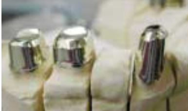
[그림 26] milling 된 primary part는 brush 를 이용하여 high polishing을 한다.
