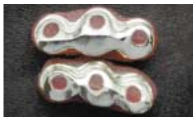
[그림43-a] hole부분에 step이 지지않도록 해야한다
