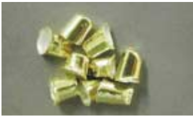
[그림 60] forming된 AGC gold coping nitric acid 30% 용액
