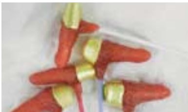
[그림 27] electroforming이 끝난 상태의 electroformed die(die는 gold coping 분리 시 손잡이 역할을 한다.)
