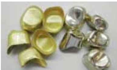
[그림 28] primary part와 nitric acid에서 silver lacquer를 제거한 상태의 electroforming gold
