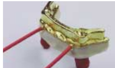
[그림 51-a] forming이 끝난 후 contact rod만 제거하면 별 다른 finishing을 하지 않아도 된다.
