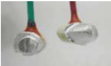
[그림5-a] 모형과 silver lacquer의 건조는 필수이며 silver lacquer도포 후 40분정도 건조시키는 것이 좋다.
