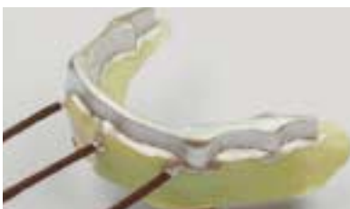
[그림 50-b] contact rod는 3개이상 설치가 곤란하므로 AGC spider를 활용하는 것이 좋다.
