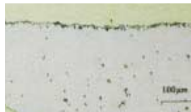
[그림 14-b] sintering후 frame(아래)과 AGC gold(위)
