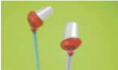
[그림 59-b] silver lacquer 건조 시에 먼지나 충 돌에 의해 벗겨지지 않도록 stand를 이용한다.
