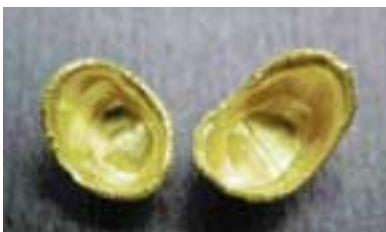
[그림6] 석고제거 후 silver lacquer를 nitric acid를 이용해 제거하였다.
