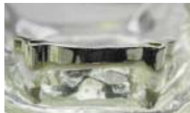
[그림 49-a] bar의 하부는 under cut이 없도록 AGC blocking-out wax 등을 이용하여 relief 하여 한다
