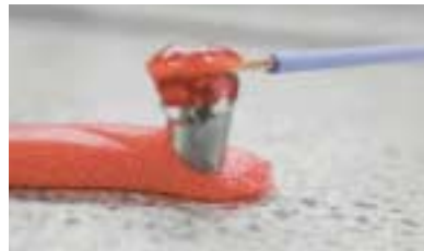
[그림 54-a] electroformed die제작 시에 utility wax를 이용하면 편리하다.
