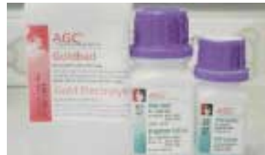
[그림 51-b] electroforming시 사용 되어지는 용액 (brightener는 electrolyte의 1/10, NEM activator는1/50 을 첨가하여 사용함)
