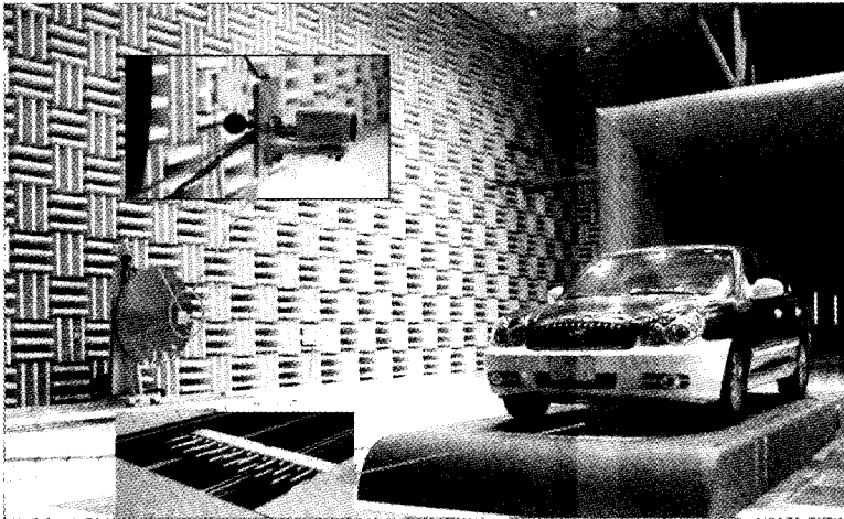
그림 6 실차 무향풍동에서 외부 바람소리 측정
