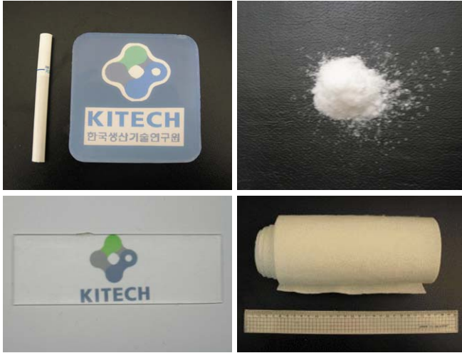
한국생산기술연구원에서 제조한 다양한 형태의 에어로겔단열재. 위쪽부터, 에어로겔 모노리스, 에어로겔 파우더, 유리 위에 코팅된 에어로겔 코팅제, 플렉시블 에어로겔 blanket 순임
