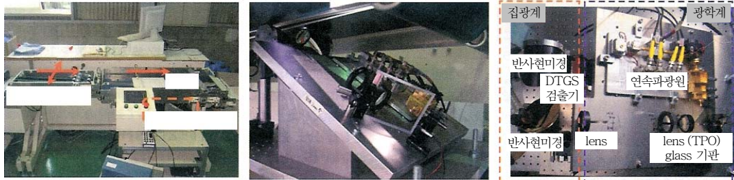
(a) 개발중인 프로토타입 전체도 (b) 입사광학계를 가로방향에서 본 그림. 렌즈들을 채택함. (c) 입사광학계의 위에서 본 그림
