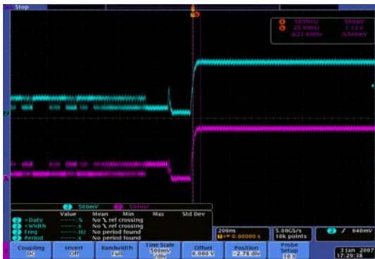
(그림 10) HS 모드에서 LP 모드로 천이하는 데이터 레인의 파형 (Fig. 10) Waveform of transition state (HS → LP mode)
