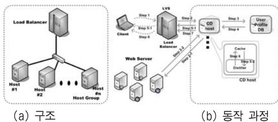
(그림 2) LVS-Cache 프록시 시스템 구조
