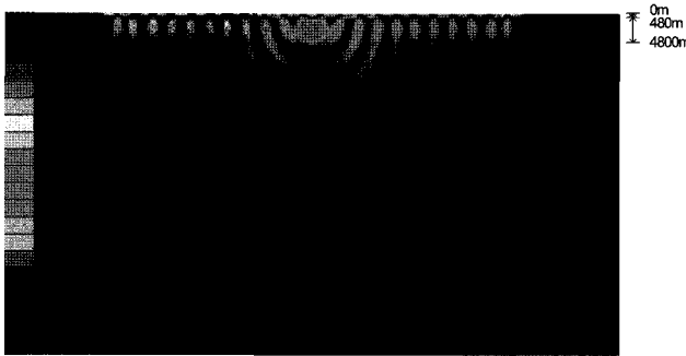
그림 10 모형 A에서의 응력전파(T=12sec)
