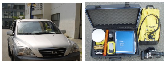
(a) 조사장비를 부착한 차량모습 (b) 실험조사장비(DGPS, Video-Camera)
