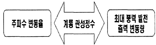
그림 2 주파수 변화율과 풍력발전용량 Fig. 2 Rate of Frequency Change and Wind Power Capacity
