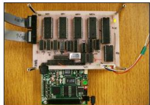
그림 11. 전자칠판 메인제어보드 Fig. 11. Main control board of electronic white-board
