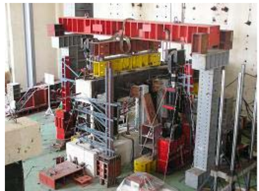
Fig. 4 실험체 설치 상황
