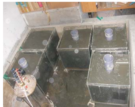
Photo 1 모형 아크릴 토조 시험 전경
