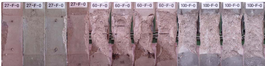
Fig. 7 콘크리트 강도별 폭렬성상(무혼입)
