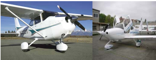
그림 1. 소형항공기 적용 전방착륙장치
