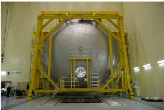
그림 30. 완공된 대형열진공챔버의 정면 모습
