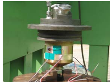
그림 4. 점화기 연소관 수압시험
