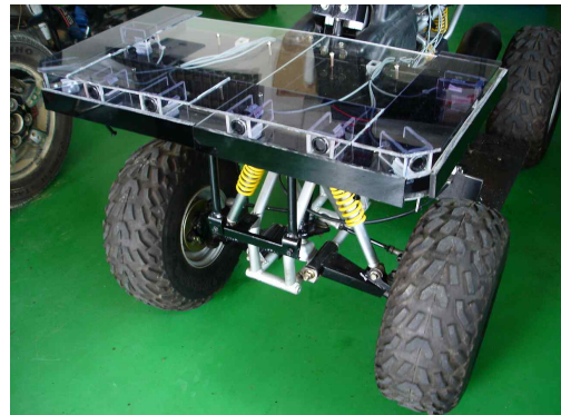
그림 1. 관성항법 시스템이 장착된 측면모습 Fig. 1. Side view of inertial navigation system installation
