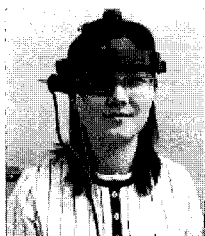
(그림 16) EOG 전극, 카메라, HMD 착용 모습
