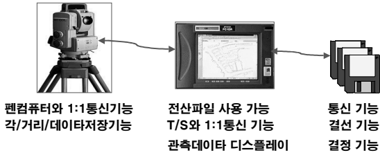
그림 1. 전자측판 측량시스템 구성도(김태훈, 2000)
