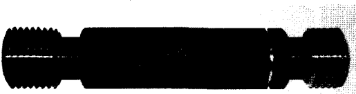
Fig. 14 Plug gauge(M30, P3.0)
