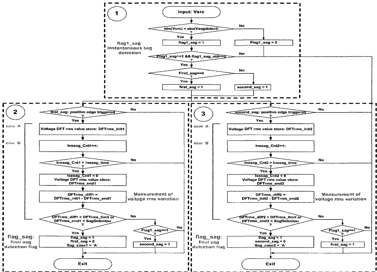
그림 3 기본파 DFT를 이용한 Sag 검출을 위한 평균치 방식 Fig. 3 Average method for Sag detection using DFT of Fundamental Frequency
