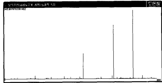
<그림 7> 제안된 식 (6)을 이용하여 나타낸 트래픽 양( \alpha=1.9 , k=1.0 , I_t^{(T=600)} 개입 (충격함수) 적용)
