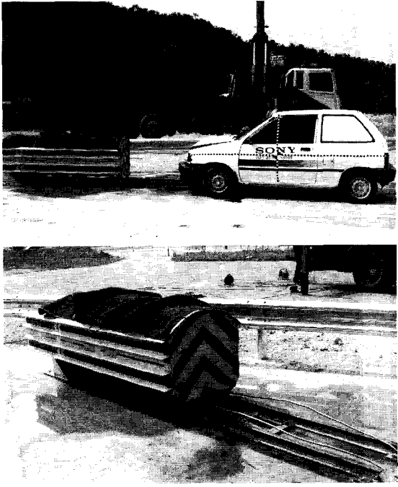
그림 12. 정면 충돌시험 후 시험체의 모습
