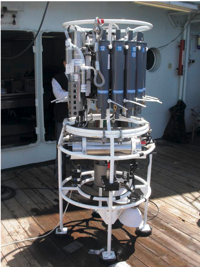
해저면에서의 관측 및 측정을 위한 탐사정비(심해저카메라, 센서, 채수기, 해저면과의 거리 유지기(BFP))
